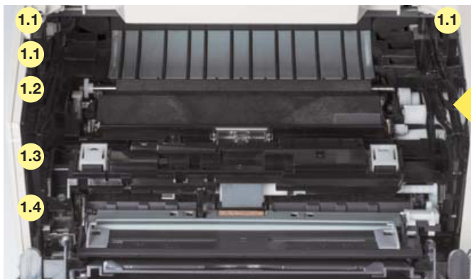
Abb. 1 Druckeransicht Kyocera FS-1320 1.1 Einschub für DR-170 1.2 Transfer-Rolle 1.3 Einschub für DV- und Toner TK-170 1.4 Tonersensor
